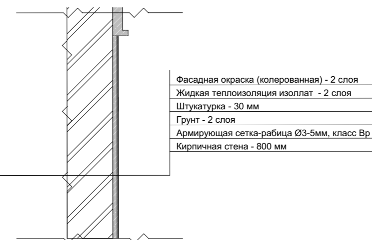
Узел покрытия отделки стен
